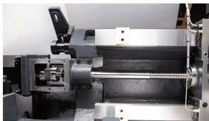
轴向均由免维护交流伺服电机驱动，大扭矩驱动电机和滚珠丝杠直接连接，大大提高了定位精度，保证更准确的螺纹与外轮廓加工，提供了更高的驱动刚性，并且不会随时间发生磨损或降低精度。
